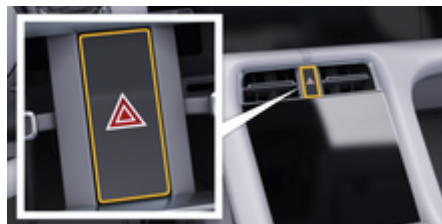
рис. 108: Увімкнення та вимкнення світлової аварійної сигналізації
