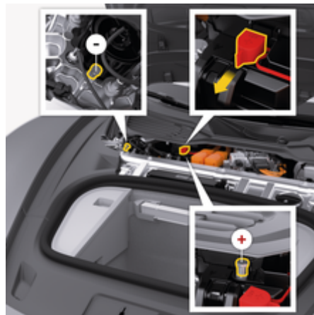
рис. 229: Полюсні клеми 12-вольтового літєвого акумулятора
