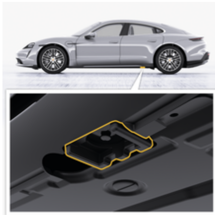
рис. 262: Точка опори для домкрата чи підйомника ззаду
