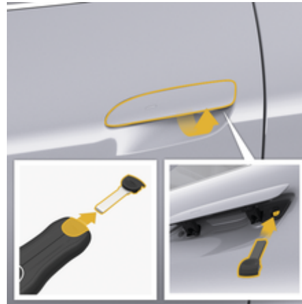
рис. 26: Виконання аварійного розблокування/блокування
