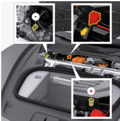
рис. 230: Полюсні клеми 12-вольтового літійового акумулятора
