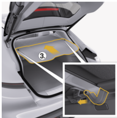
рис. 218: Монтаж задньої частини полиці багажного відсіку
