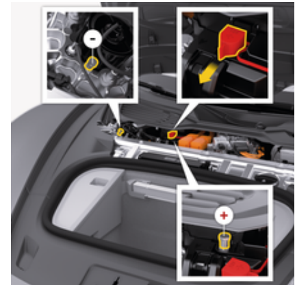
рис. 231: Полюсні клеми 12-вольтового літійового акумулятора
