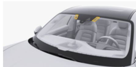
рис. 172: Кріплення пристроїв оплати дорожнього мита
