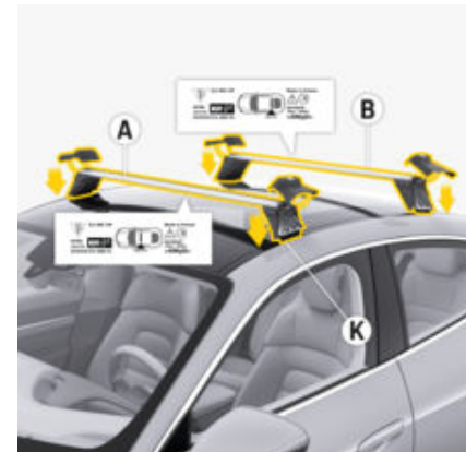
рис. 188: Установлення траверс на дах
