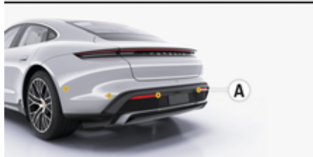
рис. 110: Ультразвукові датчики для вимірювання відстані
